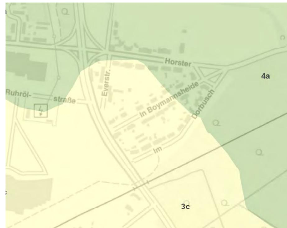
Geothermische Ergiebigkeit bei 40 Metern Sondenlänge
