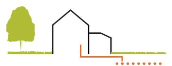
Abb. 84: oberflächennahe Geothermie, Erdkollektor
