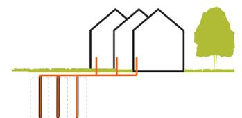
Abb. 85: oberflächennahe Geothermie, Erdsonde
