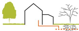
Abb. 87: Schäden am oder durch Wurzelwerk bei Erdkollektoren, Rasenflächen sind unproblematisch
