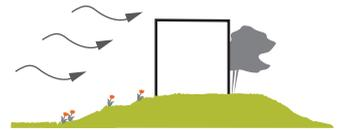
Abb. 27: Windbelastung im Freiraum bei exponierter Bebauung, erhöhter Heizwärmebedarf (+ 10 %) bei ungedämmten Gebäuden
