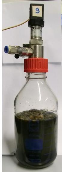
Abb. 16: Versuchsaufbau der Batch-Flaschen bestehend aus dem Reaktionsgefäß (Volumen 1 L), dem aufgesetzten Drucktransmitter und zwei Kugelhähne zur Entnahme von Gasproben.
