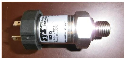
Abb. 17: Drucktransmitter der Firma STS Sensor Technik Sirnach AG zur Bestimmung der Gasproduktion.
